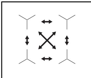
Impostando la funzione Limitazione di potenza su **superiore a 6,0 kW**, la potenza del piano di cottura viene distribuita fra il lato sinistro e il lato destro.
