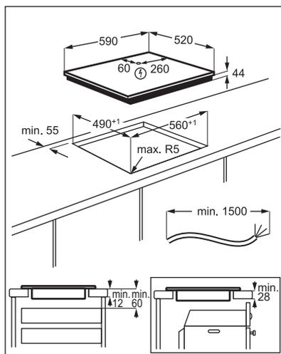
**i** Se l'apparecchiatura viene installata sopra a un cassetto, la ventilazione del piano cottura riscalda gli articoli all'interno del cassetto durante il processo di cottura.
