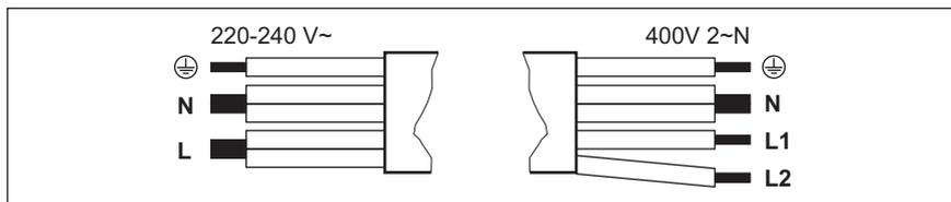
**Raccordement monophasé: 220 - 240 V~****Raccordement biphasé: 400 V 2 ~ N**
